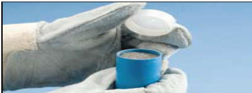
Fig. 19 Remove the lid over the mold crucible.
